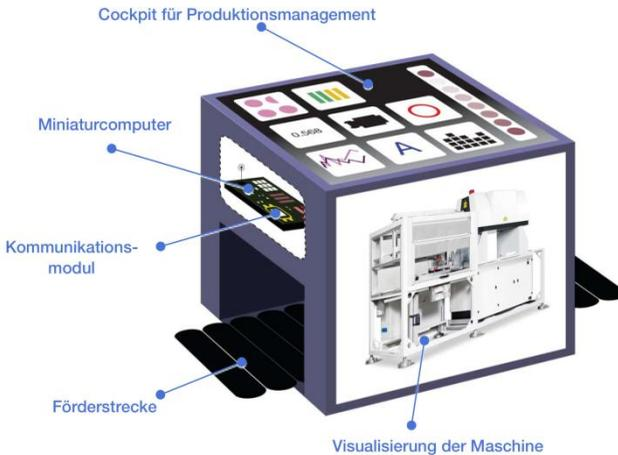
Abbildung 2: Konzeption des Werkzeugmaschinen-Demonstrators
